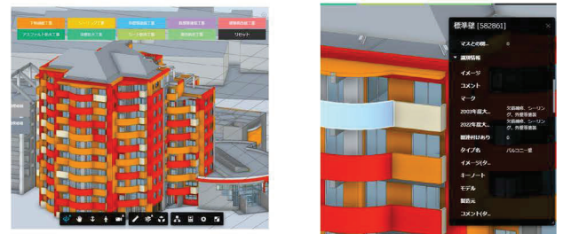
図 6 下地補修工事の表示 (橙：1 回実施 赤：2 回実施)
